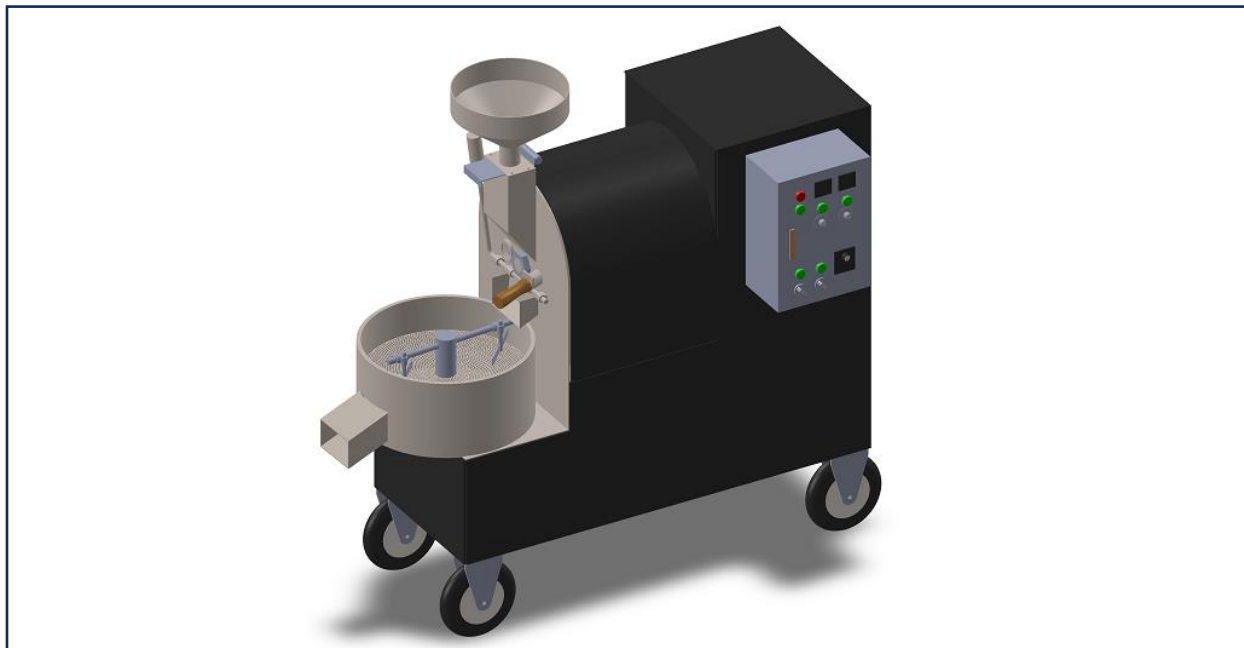
ภาพที่ 3 แบบสามมิติของเครื่องคั่วเมล็ดกาแฟขนาดเล็ก
