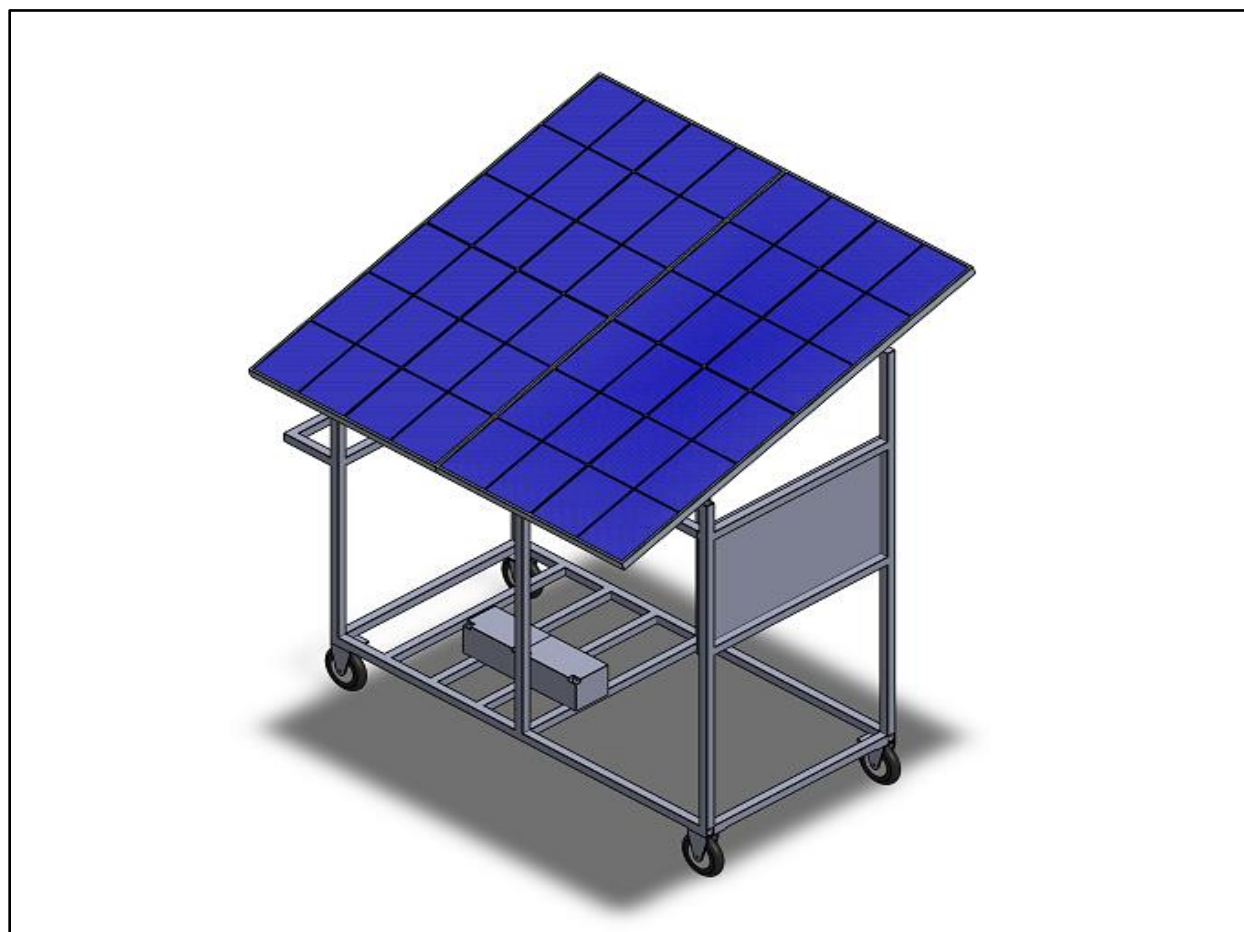
ภาพที่ 4 ชุดแผงโซลาร์เซลล์ของเครื่องคั่วเมล็ดกาแฟ
